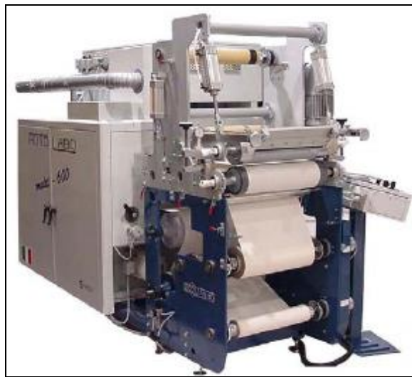
Vista general de la Rotolabo Multi 600, máquina a emplear para la aplicación de recubrimientos técnicos e impregnaciones.
