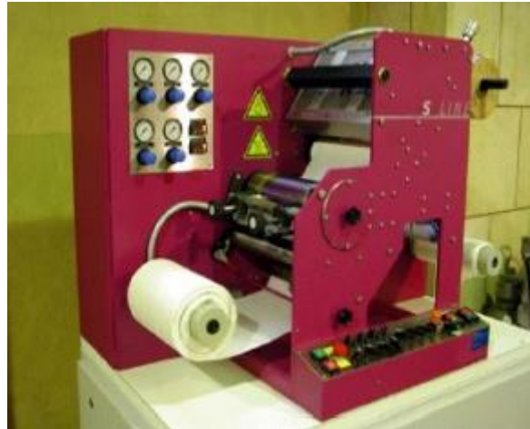
Equipo de laboratorio disponible en AITEX para la aplicación de recubrimientos y laminados con resinas/adhesivos hot-melt.
