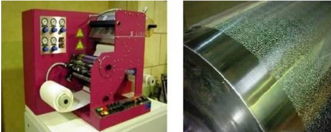
Planta aplicadora de hotmelts disponible en AITEX (izquierda) y cilindro aplicador grabado con puntos.
