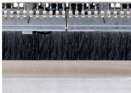
Dispositivo de sprayado de hotmelts y deposición sobre textil.
