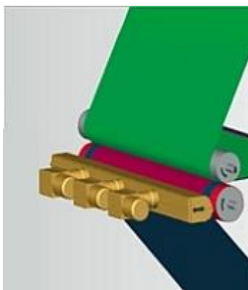
Esquema de sistema aplicador “slot die” o mediante boquilla.
