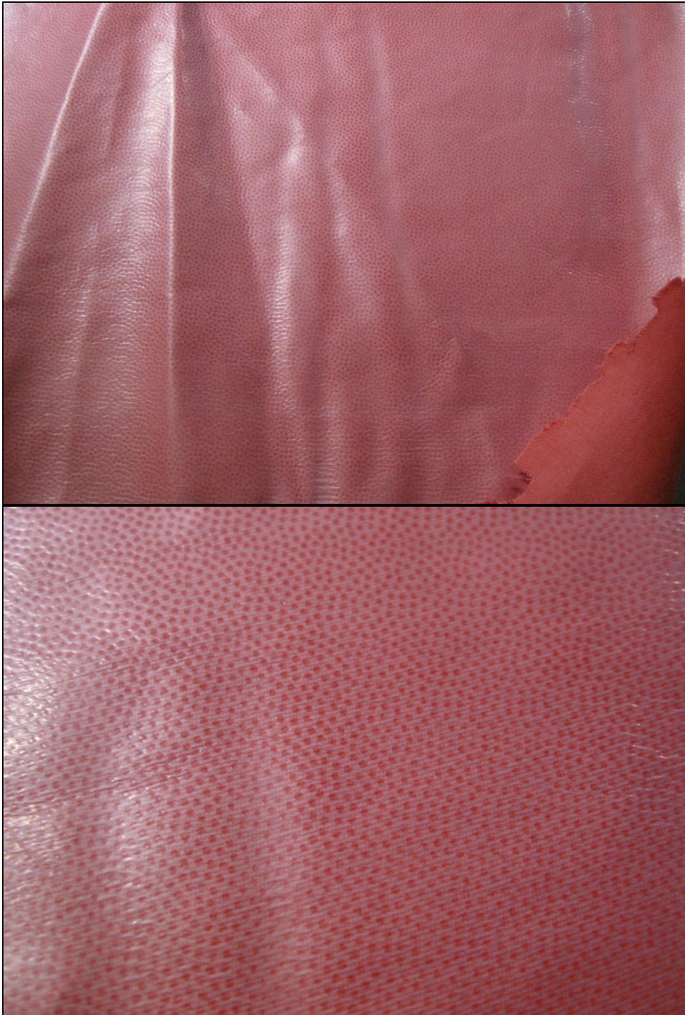
Tejido PES + membrana PES adhesivado con NEOFLEX 2780: arriba vista general; abajo detalle de la superficie laminada con los puntos característicos de la tecnología de unión por cilindro grabado.
