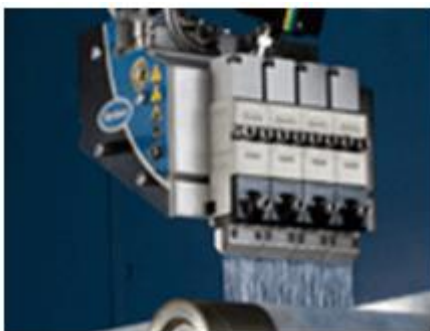
Planta aplicadora de hotmelts mediante sistema difusor de boquilla (slot die).
