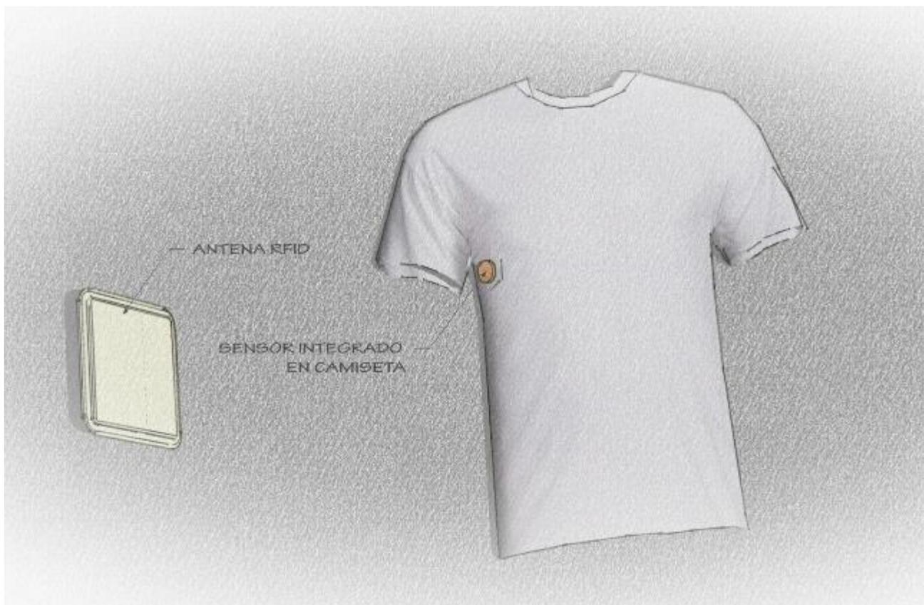
El sensor trabajará de forma independiente obteniendo mediciones mediante los sensores. Únicamente cuando se encuentre cercano a la zona de lectura los datos serán volcados al sistema para su posterior análisis.
