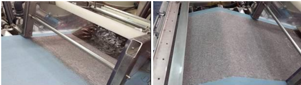
Proceso de fabricación del no tejido de residuo de orujo con la tecnología de wet-laid.
