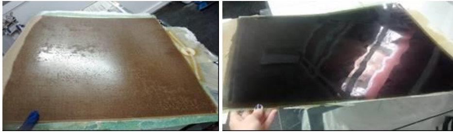
Materiales compuestos obtenidos. Izquierda: compuesto con tejido de yute. Derecha: compuesto con tejido de basalto.
