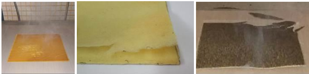
Problemáticas en el procesado de los laminados. Izquierda: gran cantidad de humos perjudiciales. Centro: problemática de deslaminado. Derecha: rotura y ondulaciones de los laminados.
