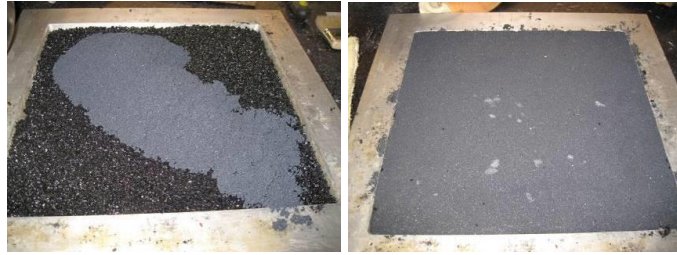
Detalle de formación de las losetas de caucho mediante proceso con granulometría variable.
