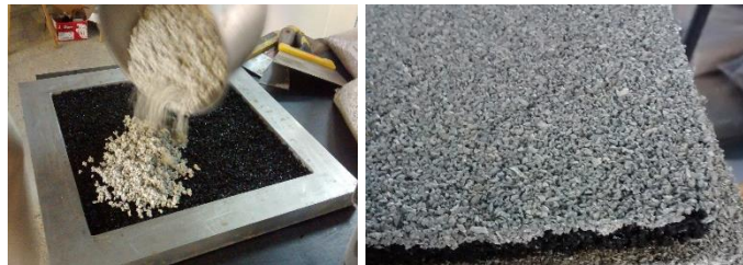
Detalle de formación de las losetas de caucho a partir de encapsulado fotocatalítico de partículas.
