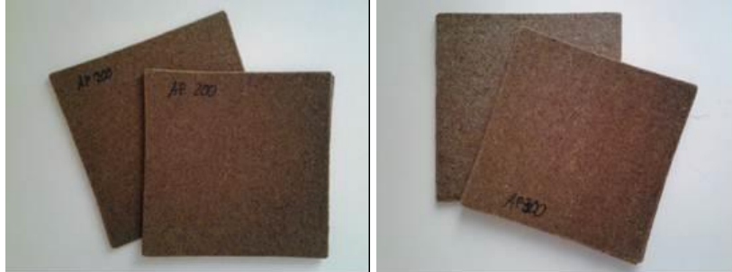
Compuesto laminado desarrollado a partir de no tejidos de residuo de orujo.
