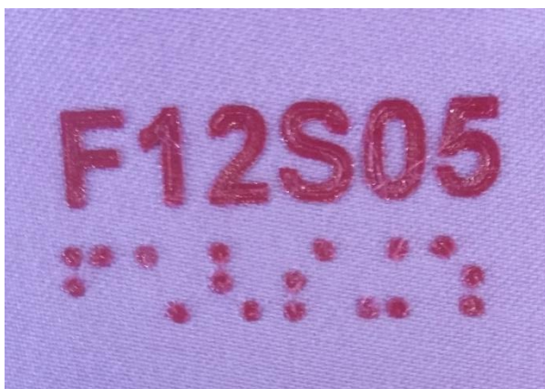
Impresión 3D de codigos Braille sobre textil
