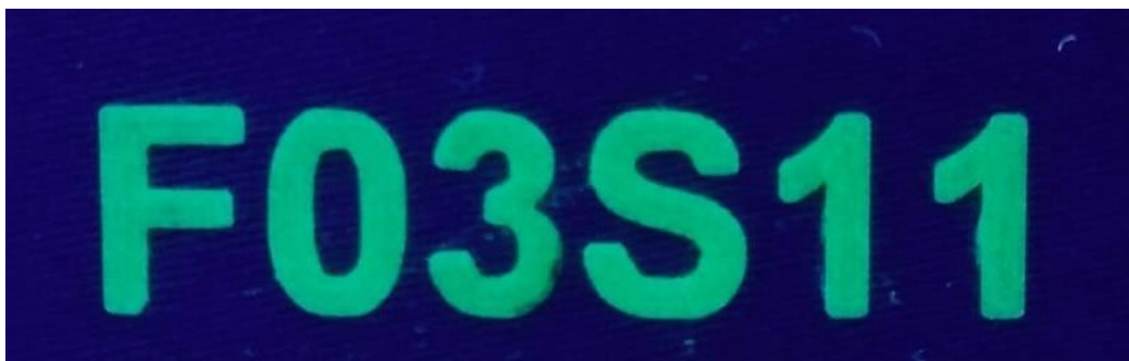
Impresión 3D de etiqueta luminiscente sobre textil
