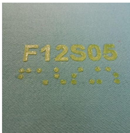
Impresión 3D de codigos Braille sobre textil
