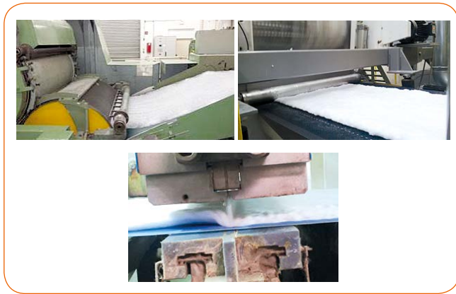
Figura 4. Proceso de fabricación de carda de un no tejido a partir de biofibras funcionales.
