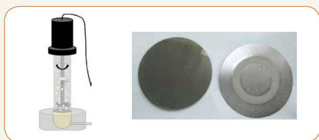
Figura 4. Izq. Diagrama del encapsulador por membrana. Dcha. Tipos de membrana.
