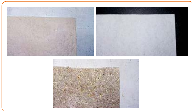
Figura 5. Ejemplo de tipología de algunos de los no tejidos desarrollados. De izquierda a derecha: No tejido de biofibra funcional; No tejido de biofibra funcional; No tejido de residuo vegetal.
