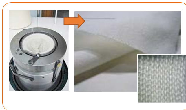
Figura 2. Tejido de punto por trama de hilo de biofibra funcional.
