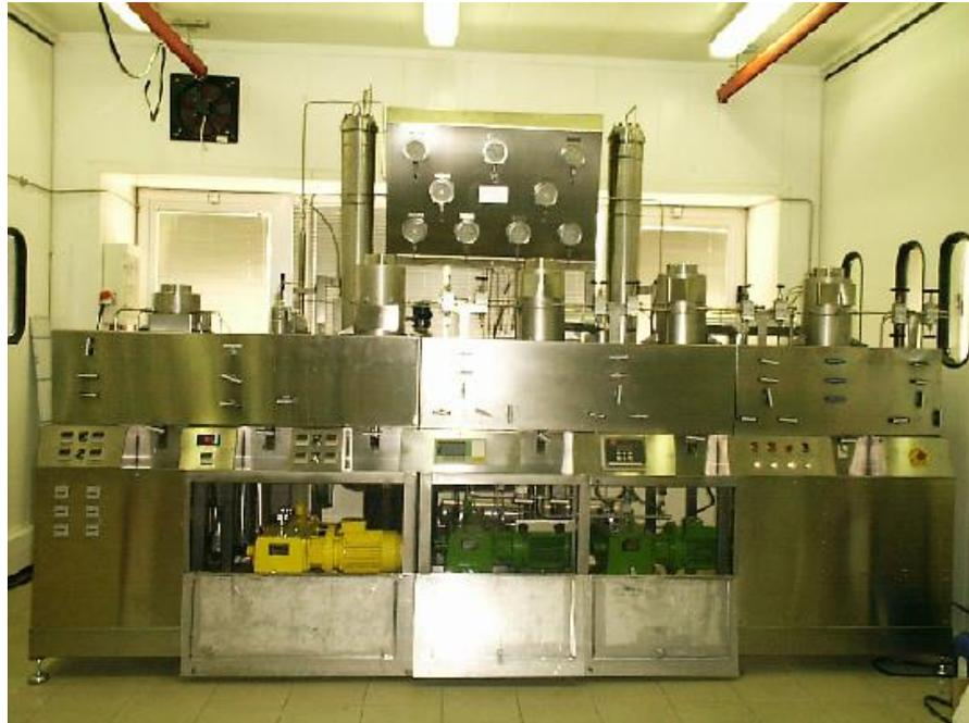
**Figura 9. Instalación ALTEX (4 extractores, 1000 L de capacidad)**
