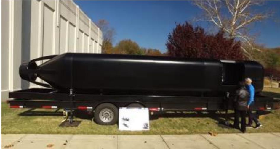
**Primer casco submarino fabricado por impresión 3D (Fuente: 3dprint.com)**
