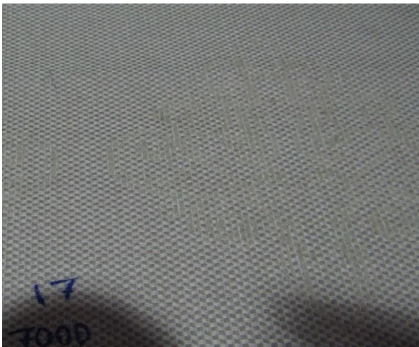
Marcado de tejido de tapicería en color crudo: izquierda) vista general donde apenas se aprecia el diseño marcado (duty cycle = 17%; velocidad = 7000); derecha) detalle de la superficie textil con las líneas marcadas por el haz láser.
