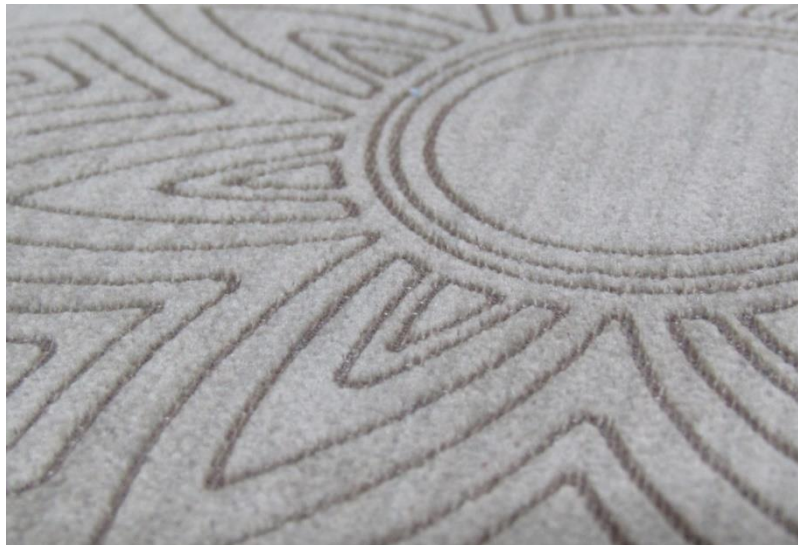
Tejido marcado con láser, para tapicería. Modo vectorial, duty cycle en el rango 30 – 50% y velocidad de marcado 2000 – 5000.
