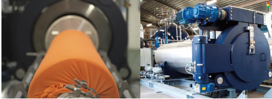
Sistema de tintura en seco empleando CO2 supercrítico, implantado en empresa (DyeCoo y Nike Inc.).
