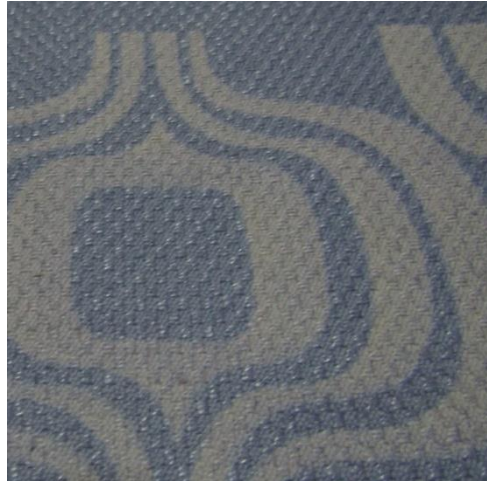
Marcado de tejido de tapicería tintado en azul, a tpx = 75 y dpi = 30. Se observa muy buena definición de trazos sin degradar el tejido.
