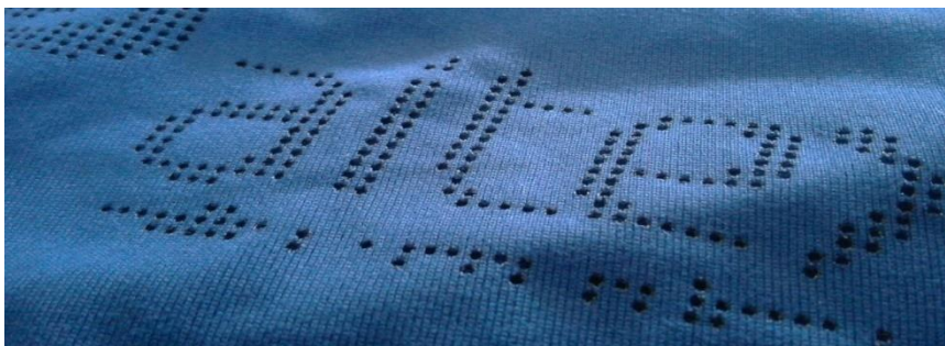
Camiseta de punto con efecto de microperforación, desarrollado con láser en FUN2GARMENT.
