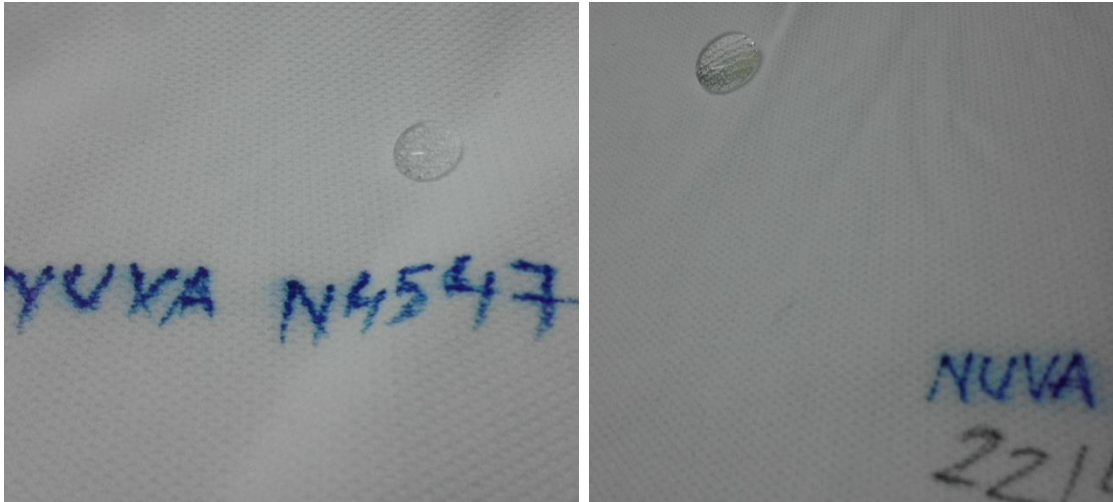
Izquierda) Acabado a 30 g/l aplicado por eFlow. Hay repelencia pero no parece suficiente, es necesario incrementar algo más la concentración; derecha) Muy buena repelencia al agua sobre tejido PES, gracias a la aplicación de acabado a 50 g/l, por micronizado con eFlow.
