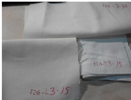
Muestras acabadas con antimicrobiano a 15-30 g/l, tejido hogar tipo loneta y tapicería.
