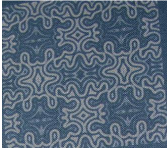
Tejido de tapicería azul claro 100% algodón, marcado a tpx = 100. Pueden realizarse marcados incluso a tpx = 250. Un lavado posterior genera el color final obtenido.
