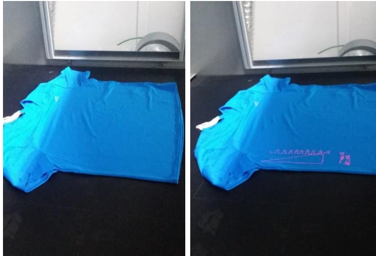
Camiseta comercial de PES en la mesa de marcado, colocando el motivo a marcar en la zona de interés (derecha). Se aprecia el contorno del motivo a marcar gracias al diodo rojo que posee el equipo, que permite ajustar exactamente la zona de marcado que se quiere.
