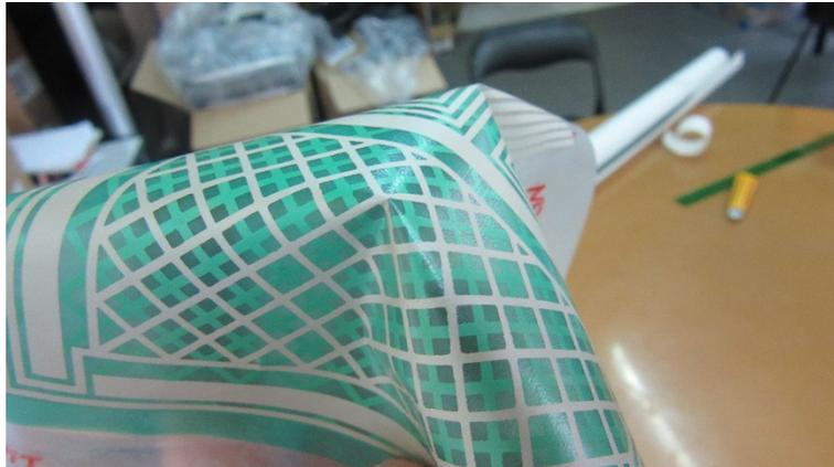
*Figura 14. Sensor háptico flexible impreso sobre sustrato textil*
