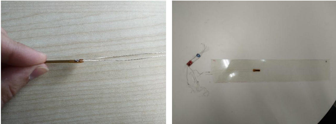
Ejemplo de dispositivo piezoeléctrico antes (izq.) y después (dcha.) de ser integrado en el composite.
