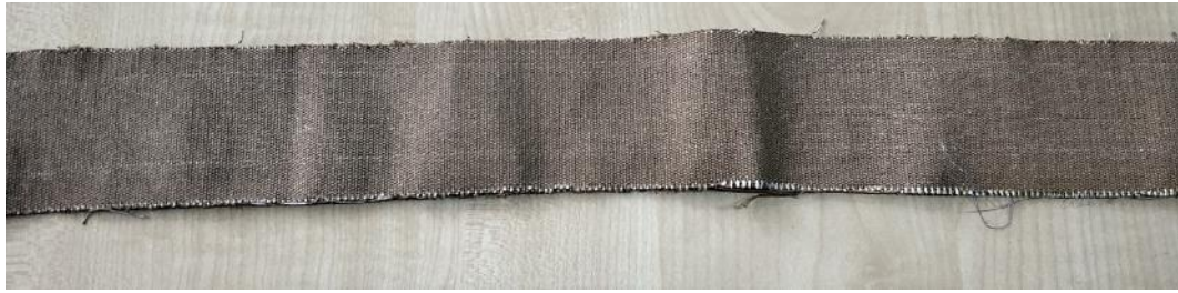
Cinta elástica obtenida con el telar de calada con hilo de elastano.
