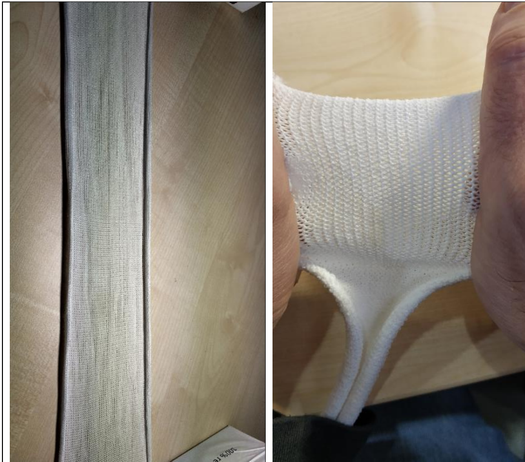
Cinta elástica obtenida con el telar de punto por urdimbre con hilo de elastano.
