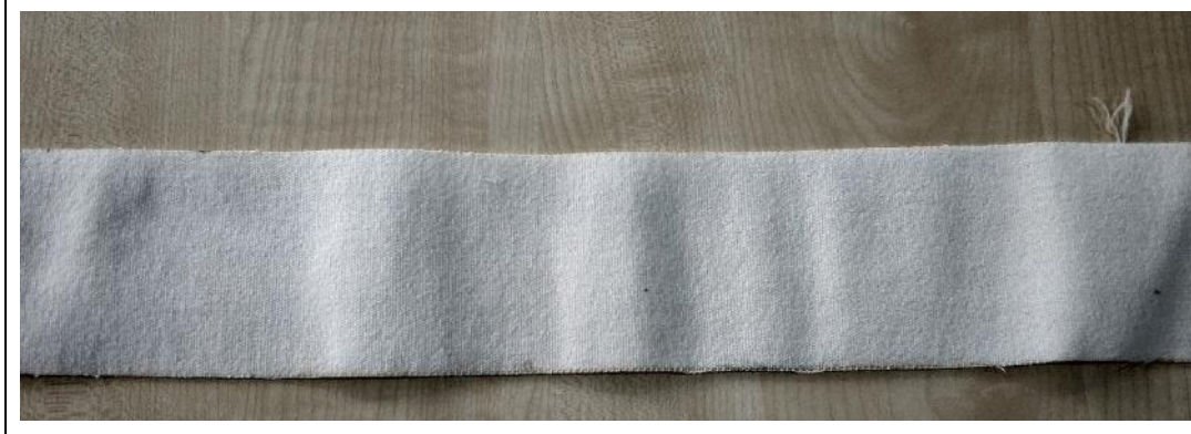
Cinta elástica obtenida con el telar de punto por urdimbre con hilo de elastano.
