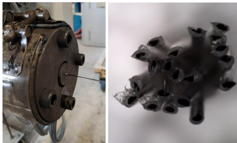
Detalle del cabezal de extrusión coating y secciones transversales de los filamentos obtenidos
