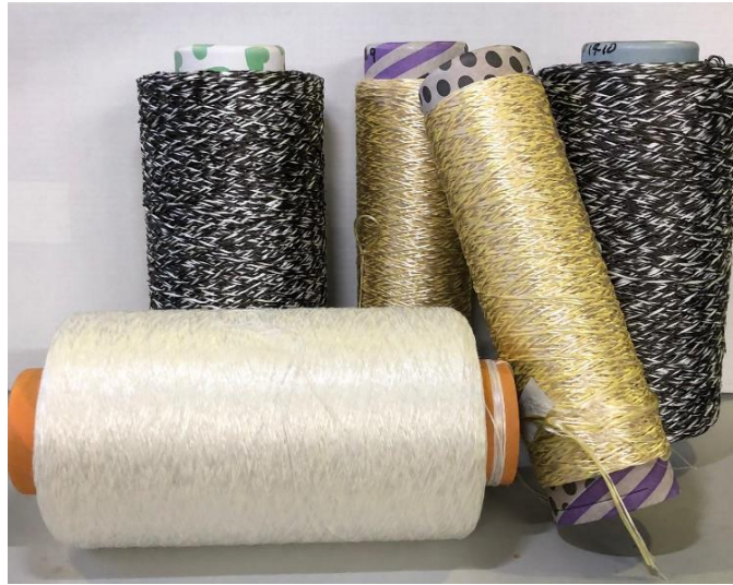
Conjunto de hilos híbridos desarrollados a partir de Fibra de carbono, Para-Aramida y Meta-Aramida
