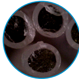
Fotografías de POF bicomponente PMMA-PVDF obtenidas con microscopio óptico
