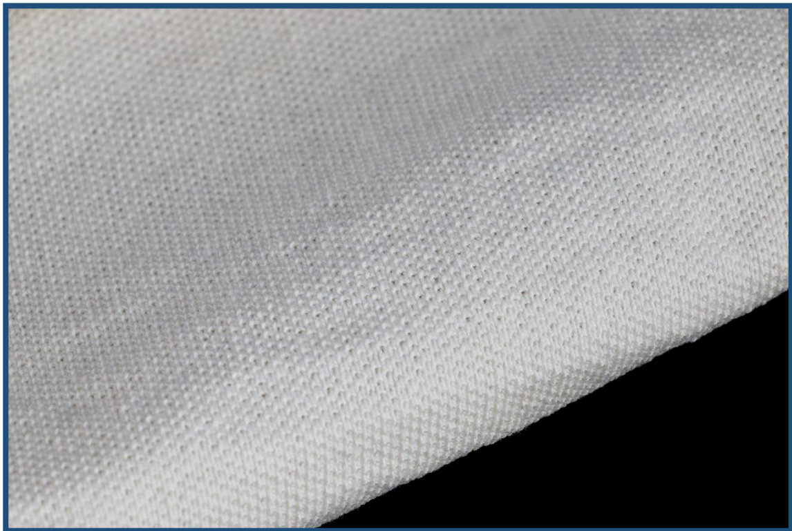
Figura 11. Tejido de punto de poliamida reciclada + 1% IN 50/50 Algodón reciclado.
