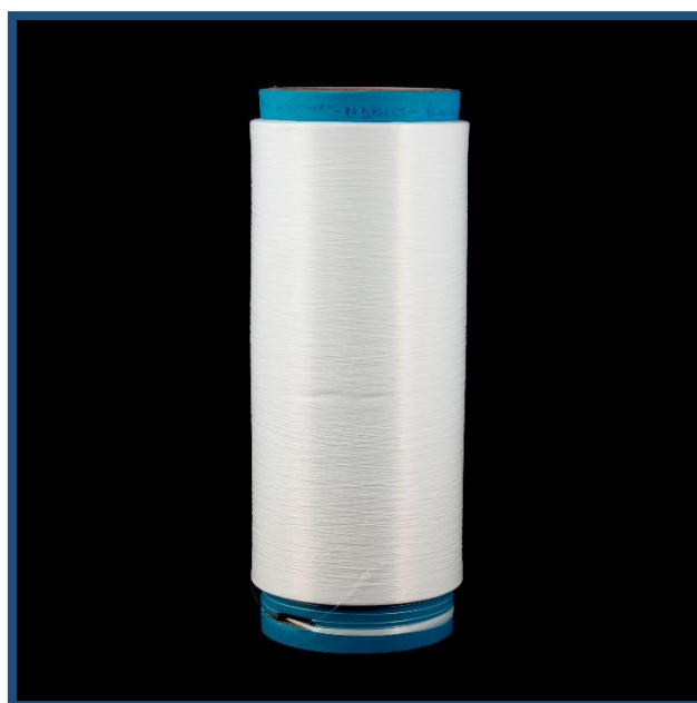
Figura 6. Bobina de hilo multifilamento de poliamida reciclada funcionalizada con un 5% del aditivo FR.
