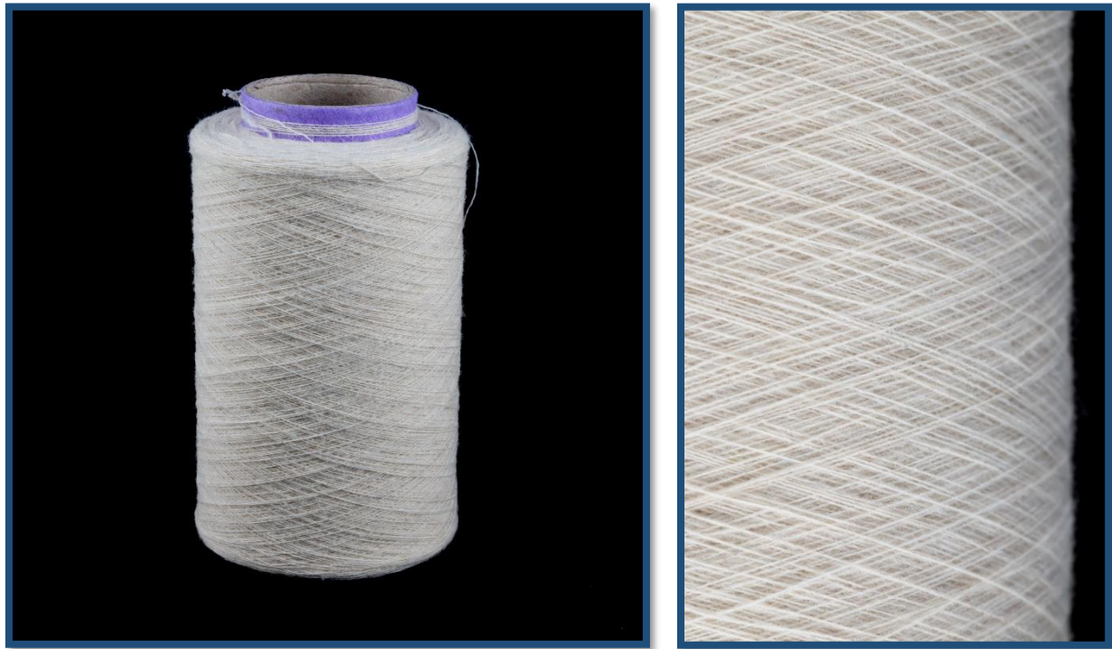
Figura 8. Izda.- Hilado de poliamida reciclada + 1% IN 50/50 Algodón reciclado.; Figura 9. Dcha.- Detalle del hilado.
