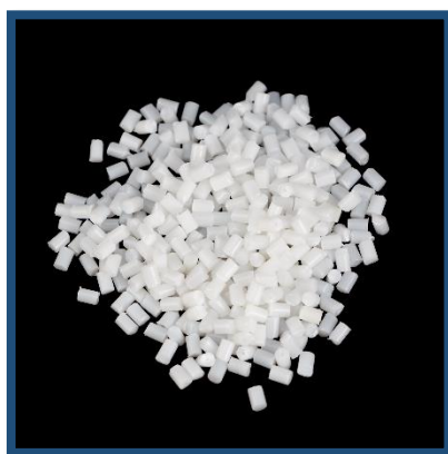
Figura 4. Formulación obtenida en forma de granza (Poliamida reciclada + 5% FR).
