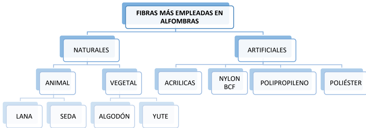
Ilustración 12: Esquema de los tipos de fibras más utilizadas en la tejeduría tufting
