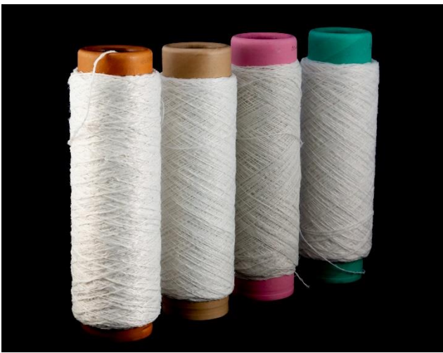
Ilustración 23: Bobinas de hilo texturizado desarrollado en el proyecto (izquierda) y comercial (derecha)
