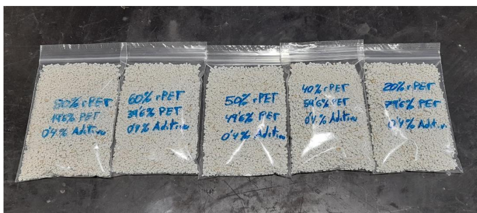
Ilustración 21: Granza de las diferentes formulaciones de rPET + PET + Aditivo
