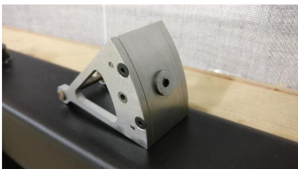
Ilustración 9: Elementos (seesaw y cuchilla) que componen la tijera del hilo en el robot de tufting
