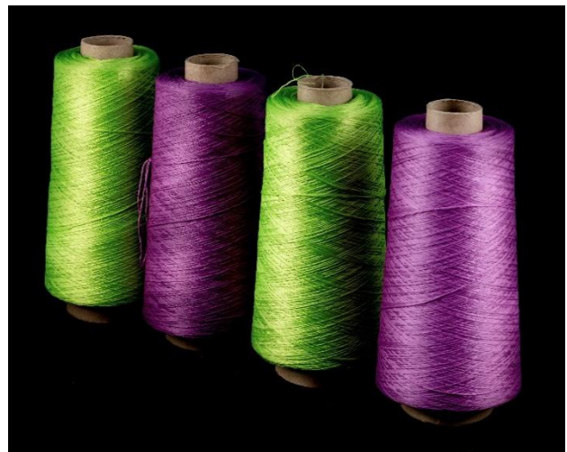
Ilustración 23: Bobinas de hilo texturizado desarrollado en el proyecto (izquierda) y comercial (derecha)
