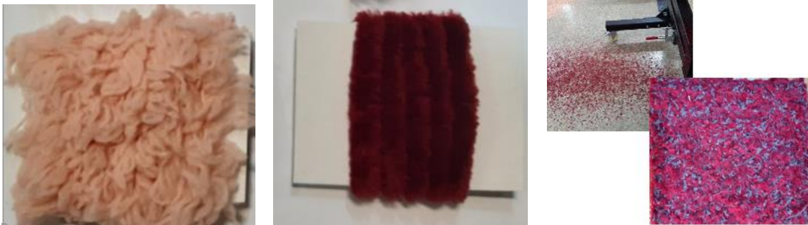
Ilustración 27: Izq.) Hilo de fantasía que no se ha podido tejer. Centro) hilo de fantasía que se ha podido tejer en determinadas condiciones y Dcha. problemas encontrados en la tejeduría y aspecto de la alfombra con el hilo de la imagen central
