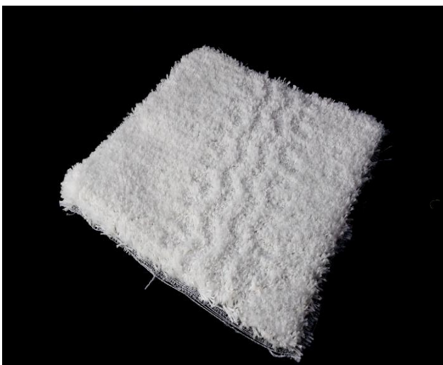
Ilustración 25: Conjunto de prototipos con diseños desarrollados en el proyecto ECORUG, empleando una combinación de hilos producidos en las tareas anuales e hilos sostenibles comerciales.
