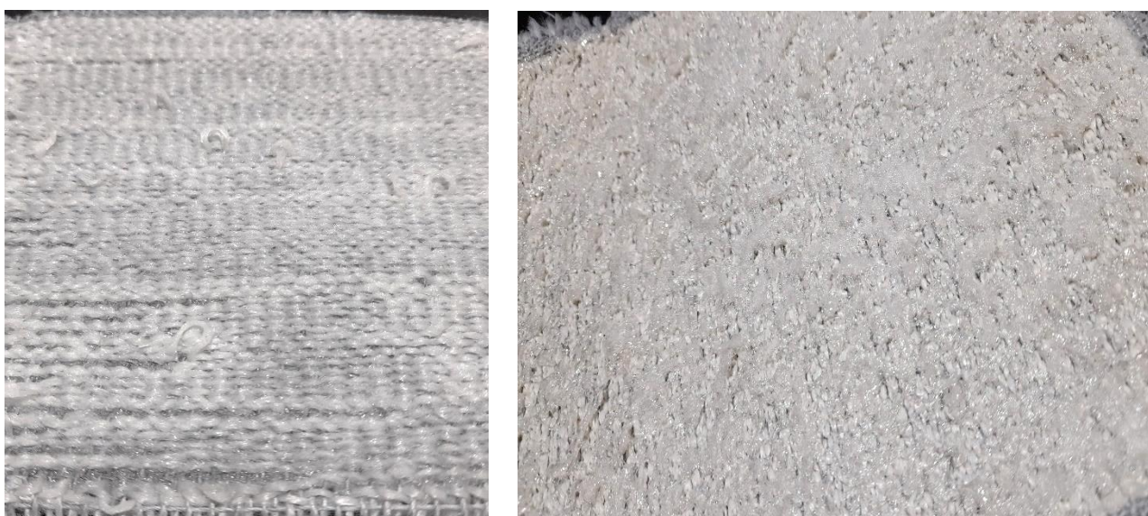
Ilustración 26: Izq.) Alfombra con látex como elemento de cohesión. Der.) Alfombra con poliéster de bajo punto de fusión como adhesivo.
