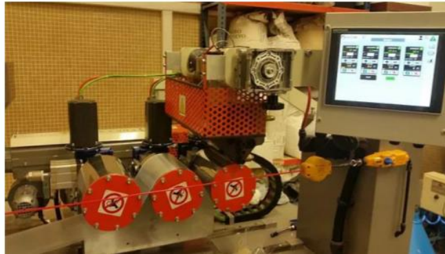
Ilustración 10. Extrusora Minicast 25 de Eurexma
