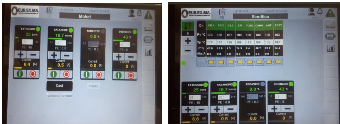
Ilustración 11. Condiciones de procesado de la extrusora de cast film para PVA
