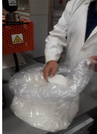
Ilustración 12. Material de partida. PVA C500 T de MOWIFLEX
