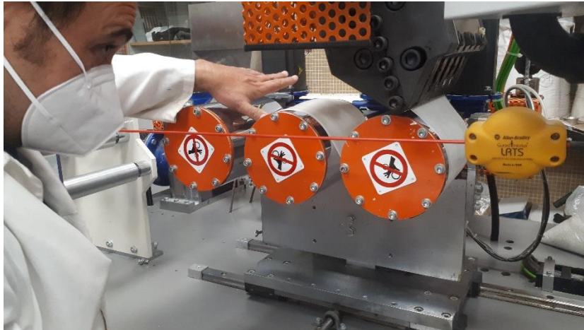
Ilustración 15. Detalle del enfriado y estirado en el sistema de rodillos fríos.
