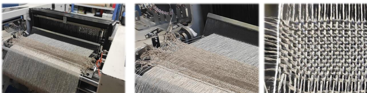
Figura 6. Telar experimental de AITEX con fibra de carbono y detalle del tejido híbrido de fibra cortada.
