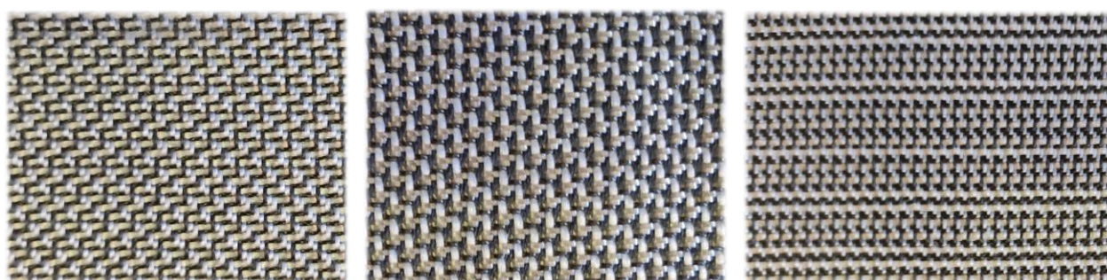
Figura 7. Diversas estructuras de tejidos híbridos mediante tejeduría de calada.
