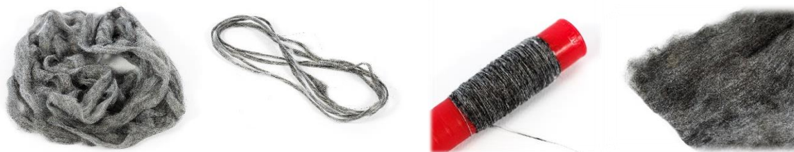
Figura 3. Cinta, mecha, hilo y no-tejido híbridos (rCF+TP) obtenidos con la planta experimental.
