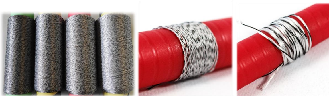
Figura 4. Distintos hilos hibridados por torcido y retorcido con variaciones en la proporción matriz/refuerzo.
