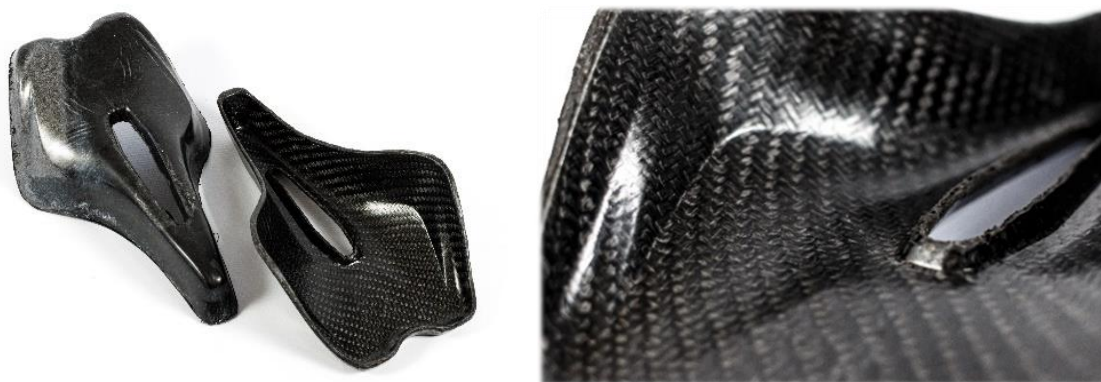
Figura 10. Sillines obtenidos (zona superior: no-tejido, zona inferior: tejido) (izq.). Detalle del acabado (dcha.)
