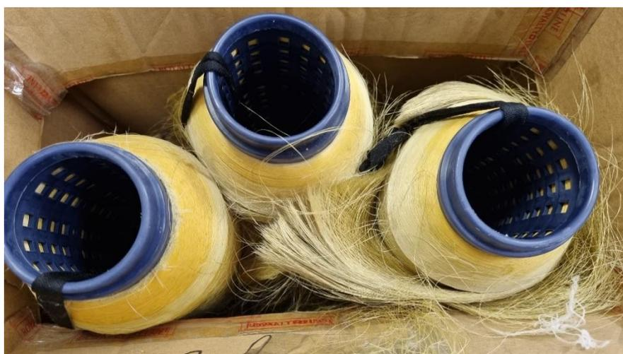
*Figura 10. Bobinas de PLA tras el proceso de tintura en autoclave.*
