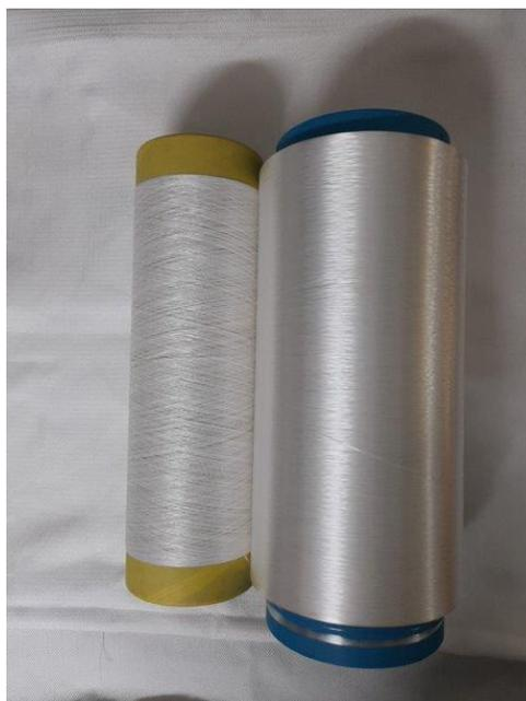
*Figura 8. Bobinas de multifilamento de PLA obtenidas tras la hilatura y el texturizado DTY.*
