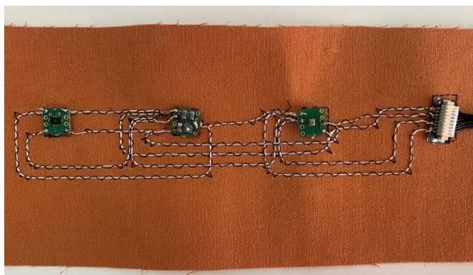
Ilustración 1. Integración de sensores en el tejido
