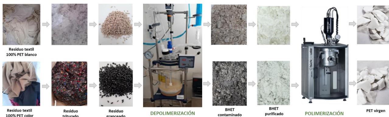
Figura 4. Reciclado químico de residuos textiles de poliéster a escala piloto.
