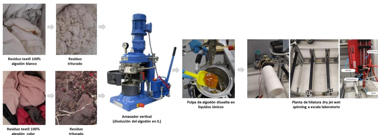
Figura 5. Reciclado químico de residuos textiles de algodón a escala laboratorio (Ioncell-F).
