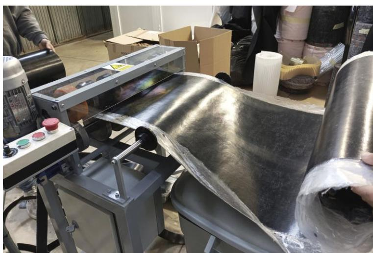
*Proceso de corte de las rebabas de las preformas planas.*
