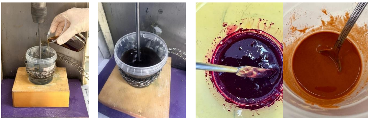
Ilustración 4 Adición de polioli sobre isocianato (izq), homogeneización mecánica de fases (centro) y homogeneización manual de resinas con colorantes o cargas (der)
