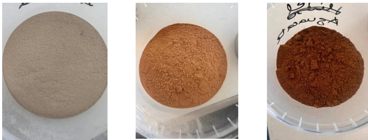
Ilustración 10 Cargas de origen bio utilizadas durante el proyecto. Hueso de aceituna (izq), hueso de aguacate (centro) y piel de aguacate (der)
