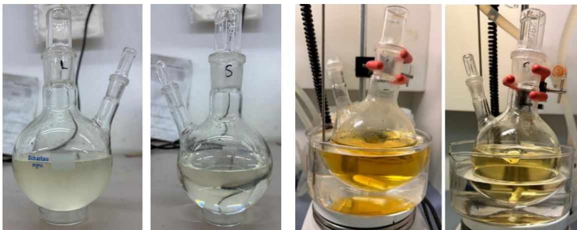
Ilustración 1 Aceite epoxidado de lino y soja mezclados con ácido acético glacial (izq) y montaje de reacción para la acetilación del aceite lino y soja (der).
