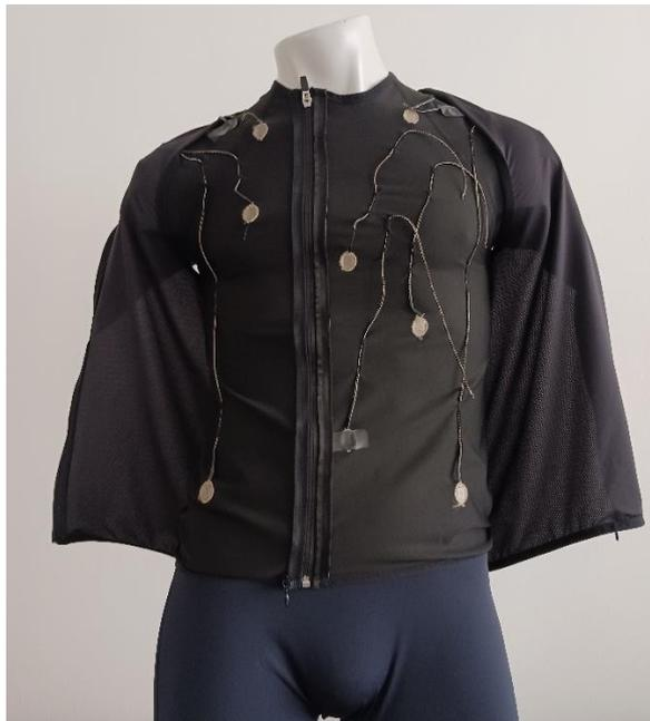
Figura 5. Prenda de monitorización de ECG con distintos electrodos bordados distribuidos por el torso.
