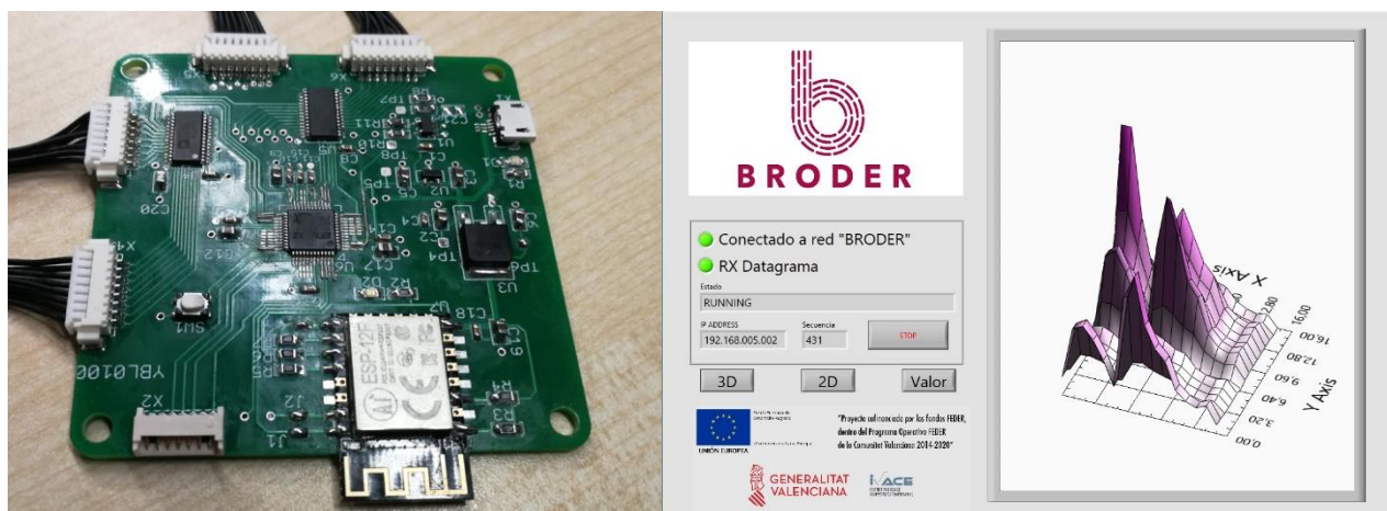
Imagen 6. Dispositivo electrónico de control y software desarrollado para el funcionamiento de la matriz
