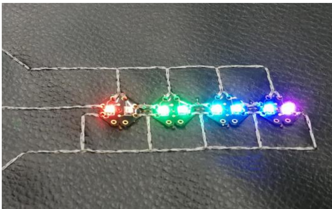
Imagen 13. Prototipo que incorpora lentejuelas con leds RGB
