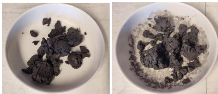
Imagen 3: Lodo crudo –Vermicompost del lodo realizado con lombrices durante 56 días.
