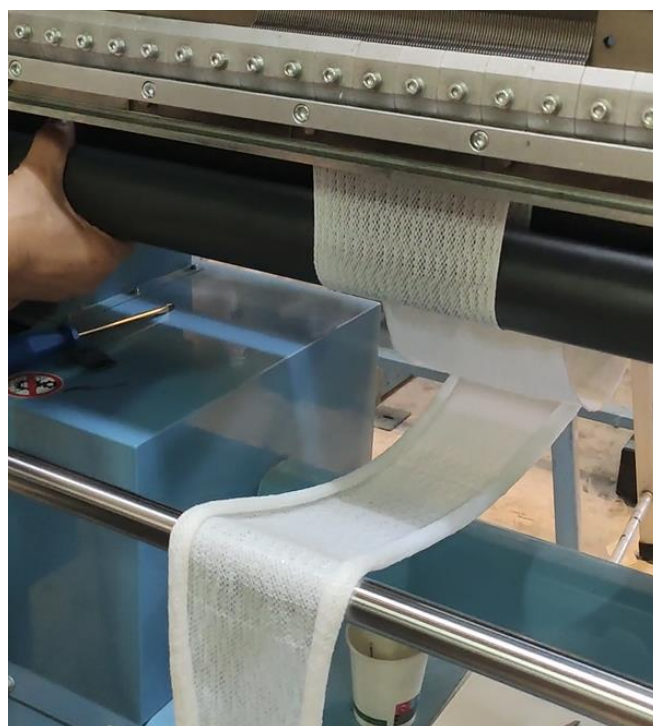
Tejido de punto por urdimbre fabricado a partir de hilos de rPET monofilamento desarrollados en el proyecto ECOMELT.
