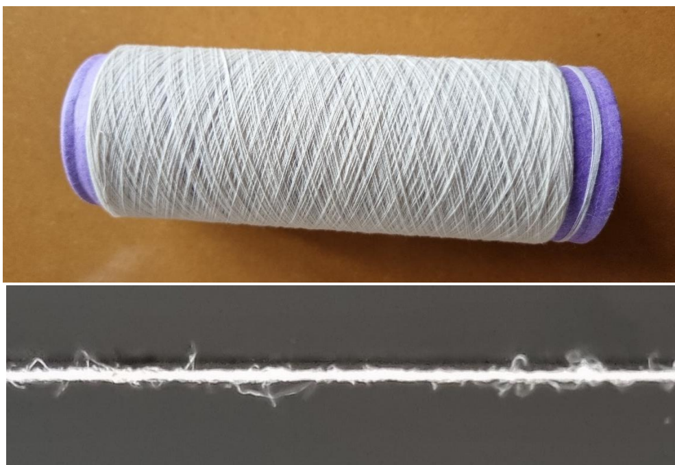
Bobina de hilado Open-end de rCOT 70/30 PLA desarrollado en el proyecto ECOMELT (Arriba) y detalle del hilado (Abajo).
