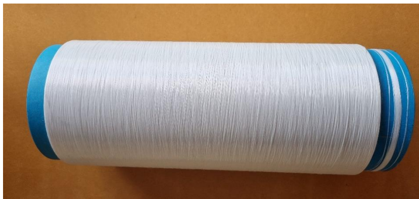
Bobina de hilo multifilamento de rPET desarrollado en el proyecto ECOMELT.
