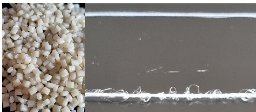
Granza de PBS + ENZIMAS y comparativa del hilo multifilamento de PBS + ENZIMAS (Arriba) y el hilo texturizado ATY de PBS + ENZIMAS (Abajo).
