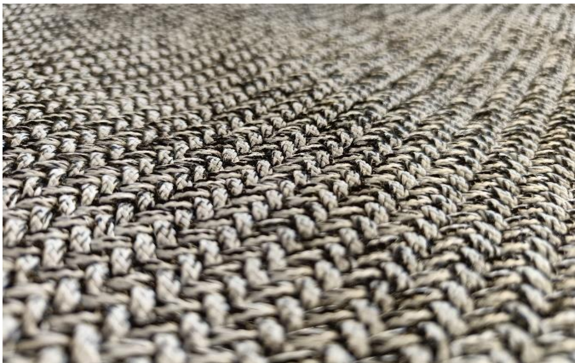
Ilustración 3: Tejido híbrido a partir de braiding
