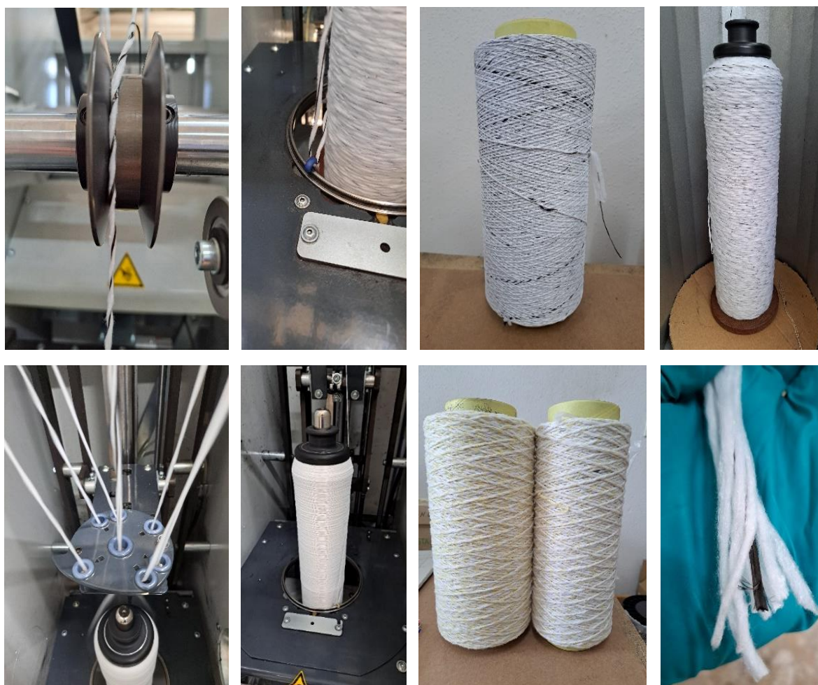
Ilustración 4: Imágenes del proceso de hibridación por torsión
