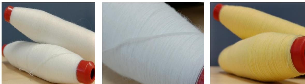
Ilustración 6: Bobinas obtenidas por hilatura de anillos
