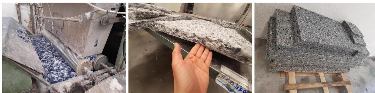
**Elaboración de prototipos mediante prensado de no tejidos**
