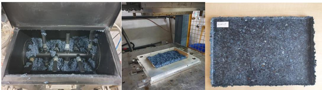
**Elaboración de prototipos mediante encolado**
