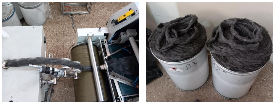
Figura 5. Optimización del proceso de obtención de cinta de carda (izq.) Cinta de carda resultante
