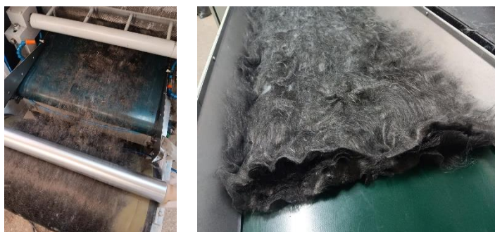
Figura 6. Obtención de velo (izq.) y Velo 80% rCF 20% PA6 (dcha.)
