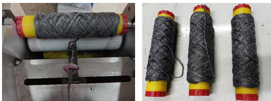
Figura 8. Bobinado de mecha (izq.) y mechas obtenidas (dcha.)
