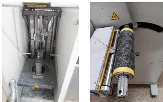
Figura 9. Hilatura por retorcido (izq.) e hilo bobinado (dcha.)
