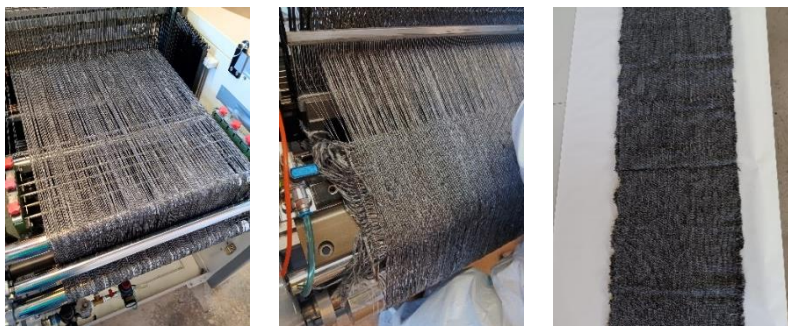
Figura 10. Detalle de la urdimbre (izq.), elaboración del tejido (centro) y tejido 50%rCF- 50%PA6
