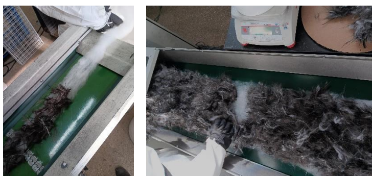
Figura 4. Alimentación de la mezcladora (izq.) Mezcla obtenida para cardar (dcha.)
