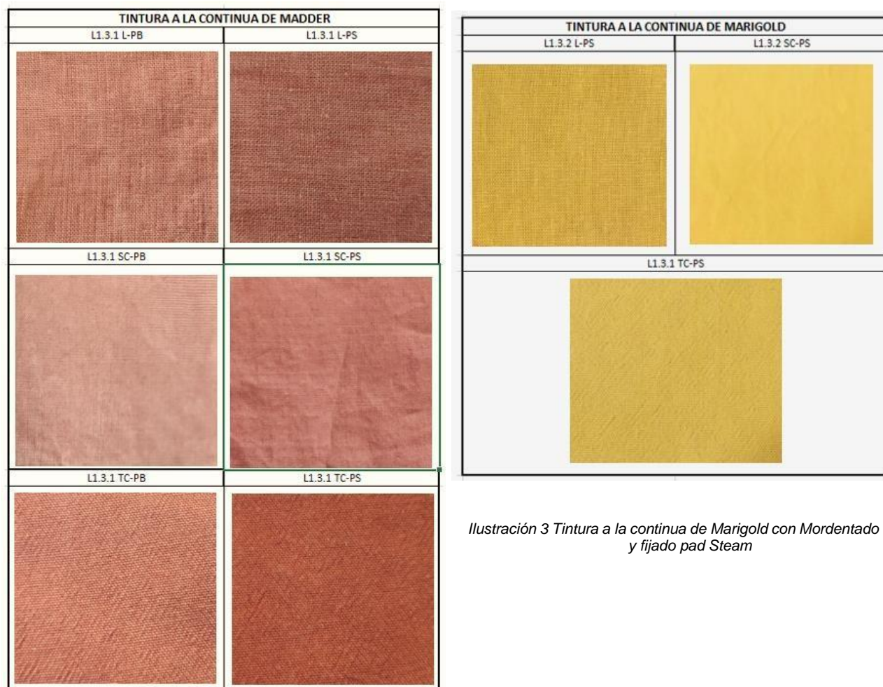
Ilustración 2 Tintura a la continua de Rubia (madder) comparativa de fijado pad Seam (PS) a pad batch (PB)
