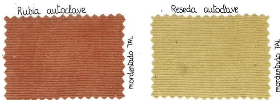
Ilustración 13: tinturas realizadas con extracción por autoclave de Rubia y Reseda.
