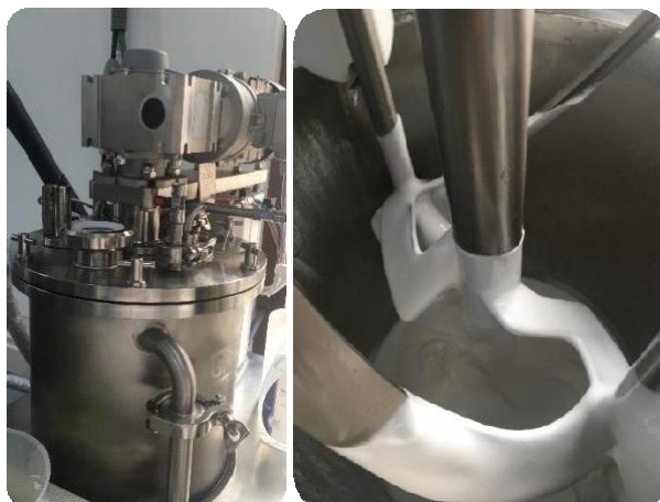
Ilustración 2. Escalado de fórmulas cosméticas en reactor de 15L para el estudio de la viabilidad industrial de las formulaciones cosméticas.
