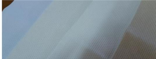
Estas estructuras han sido analizadas en base a los procedimientos para la determinación de sus propiedades de permeabilidad al vapor de agua, absorción de vapor de agua y su coeficiente de vapor de agua. Se consigue mejorar las prestaciones de permeabilidad al vapor de agua de un tejido comercial en un 80%, y del coeficiente al vapor de agua en un 70%.
