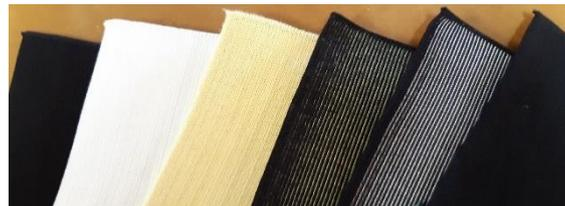
Para verificar el correcto funcionamiento de los prototipos, se ha procedido a la determinación de la resistencia al corte por objetos afilados según la norma UNE-EN ISO 13997 y se ha establecido un nivel de prestación según los valores que marca la norma. Se ha conseguido alcanzar con el tejido TEX4FOOT Security una resistencia al corte de 34,3 Newtons, correspondiente al nivel máximo de prestación (NIVEL F) que marca la norma.
